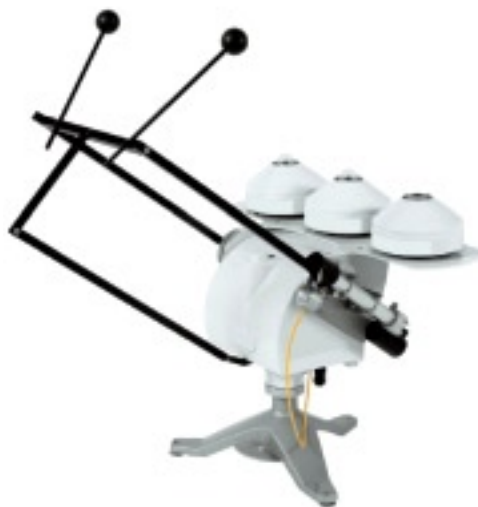
Rys. 8. Znormalizowana konstrukcja układu do śledzenia Słońca z pyranometrami zacięnionymi przez kule. Po prawej stronie widoczny jest przytwierdzony pyrhelemetry (źródło: Campbell Corp)
