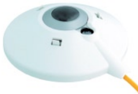
Rys. 9. Pyrgeometry służący do pomiaru natężenia promieniowania długofalowego (źródło: Campbell Corp)
